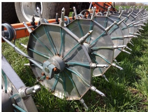
Рисунок 3 – Самоходный агрегат-мультиинжектор ООО «Пегас-Агро»-«Туман-2» с рабочими органами для внутрипочвенного внесения жидких удобрений
