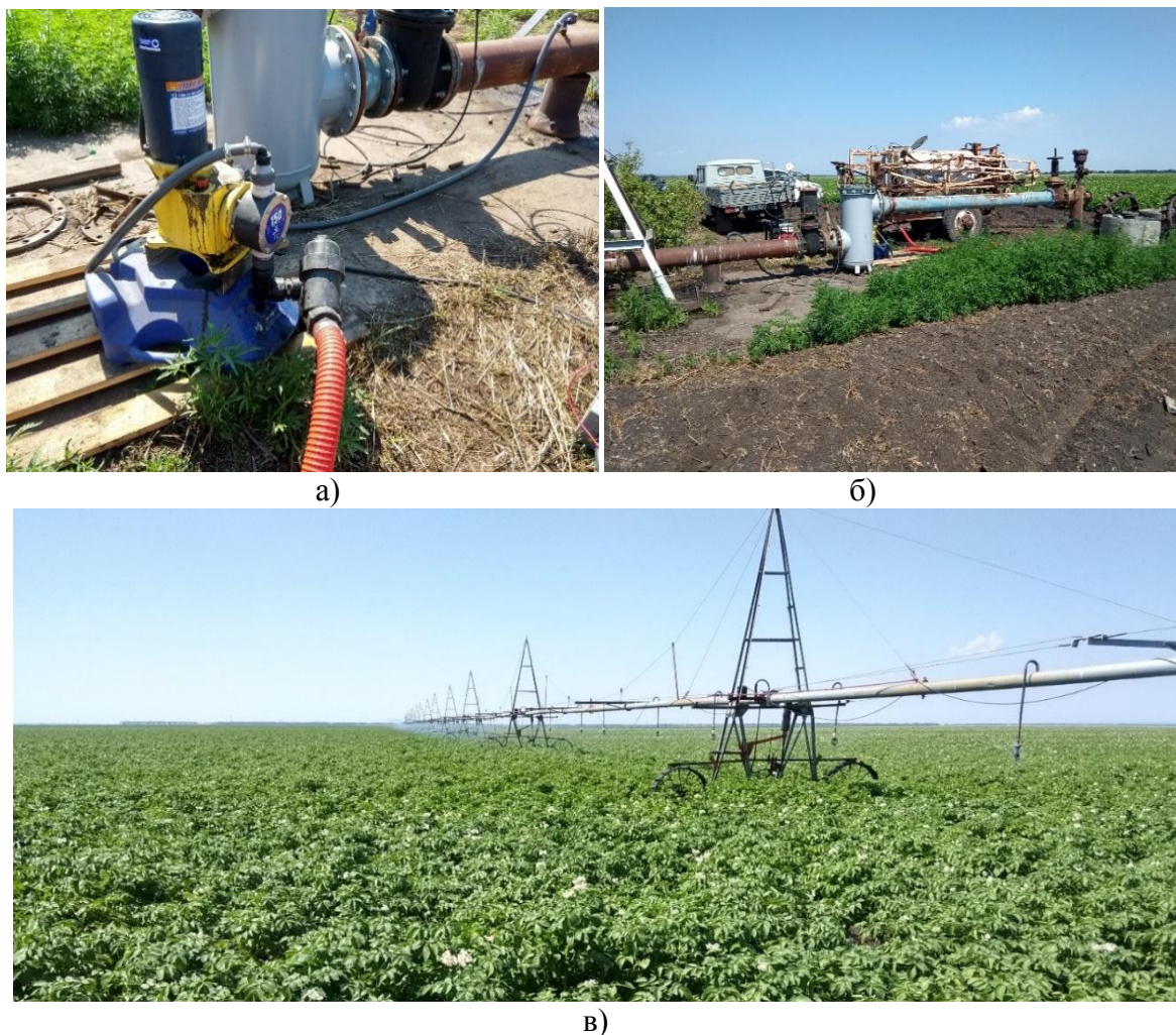
Рисунок 1 – Подкормка картофеля жидкими минеральными удобрениями КАС: а) дозатор с приводом от мобильной электростанции, б) ёмкость опрыскивателя для КАС, в) дождевальная установка «Фрегат» на поливе картофеля с подкормкой КАС-32 и КАС+S
